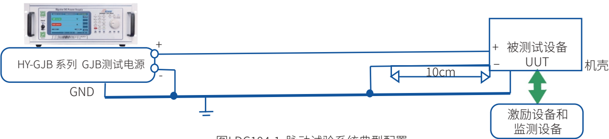
图LDC104-1 脉动试验系统典型配置
