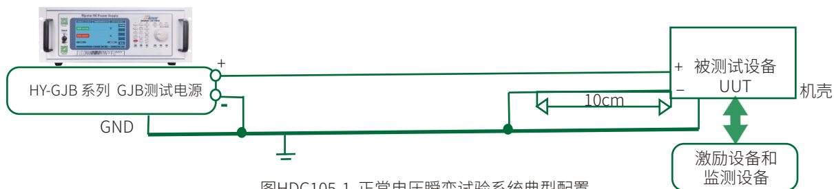
图HDC105-1 正常电压瞬变试验系统典型配置
